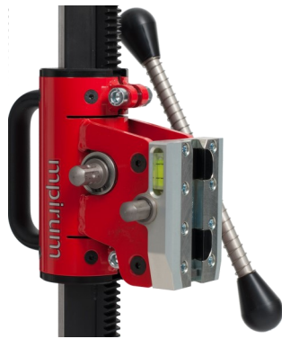
40 + matarhus med universal-snabbkoppling på ger en stark och kompakt motorinfästning.
