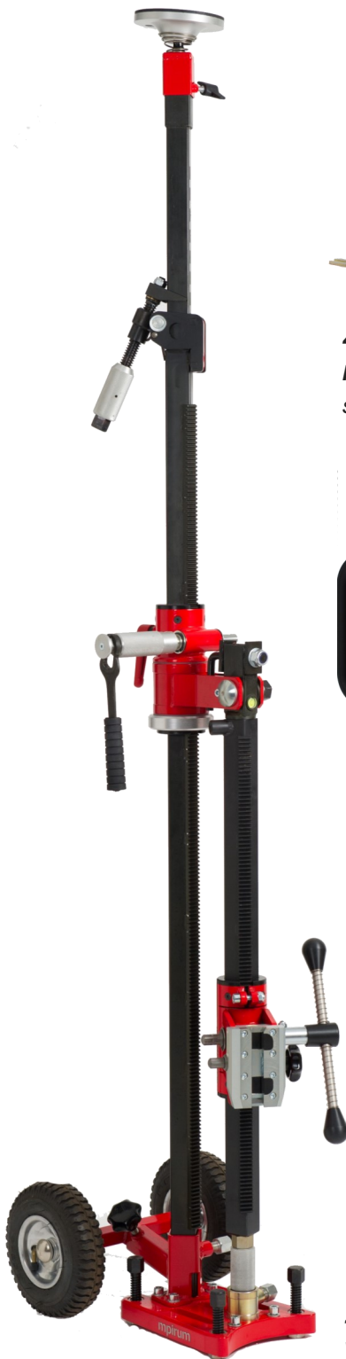
40 + matarhus med universal-snabbkoppling på ger en stark och kompakt motorinfästning.
